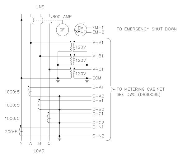
PANEL B2 METERING SCHEMATIC
