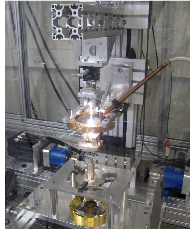
THE IMAGE ABOVE SHOWS A CLOSE UP OF THE THE SILICA STOCK BEING HEATED BY THE LASER AT THE BEGINNING OF THE FIBRE PULLING PROCESS.
